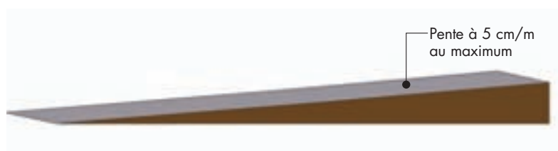
Rampe d'accès sans palier
